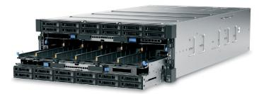
Obere und untere Rechenschächte gleiten für einfache Upgrades und Wartungsarbeiten aus der Vorderseite des Gehäuses
